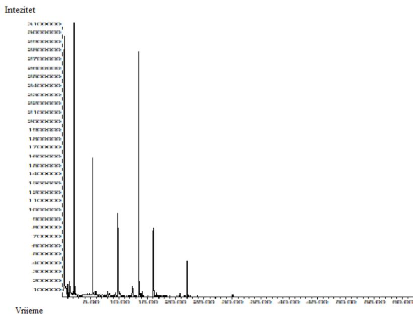
**Slika 19.** Kromatogram ukupne ionske struje hlapljivih spojeva piva stila *pale lager* izoliranih HS-SPME metodom s ovojnicom DVB/CAR/PDMS (sivo vlakno).
