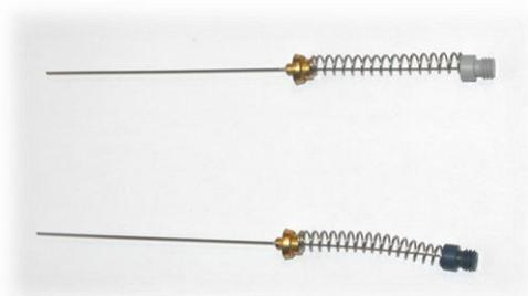
**Slika 17.** Vlakna s ovojnicama DVB/CAR/PDMS (sivo vlakno) i PDMS/DVB (plavo vlakno).<sup>38</sup>
