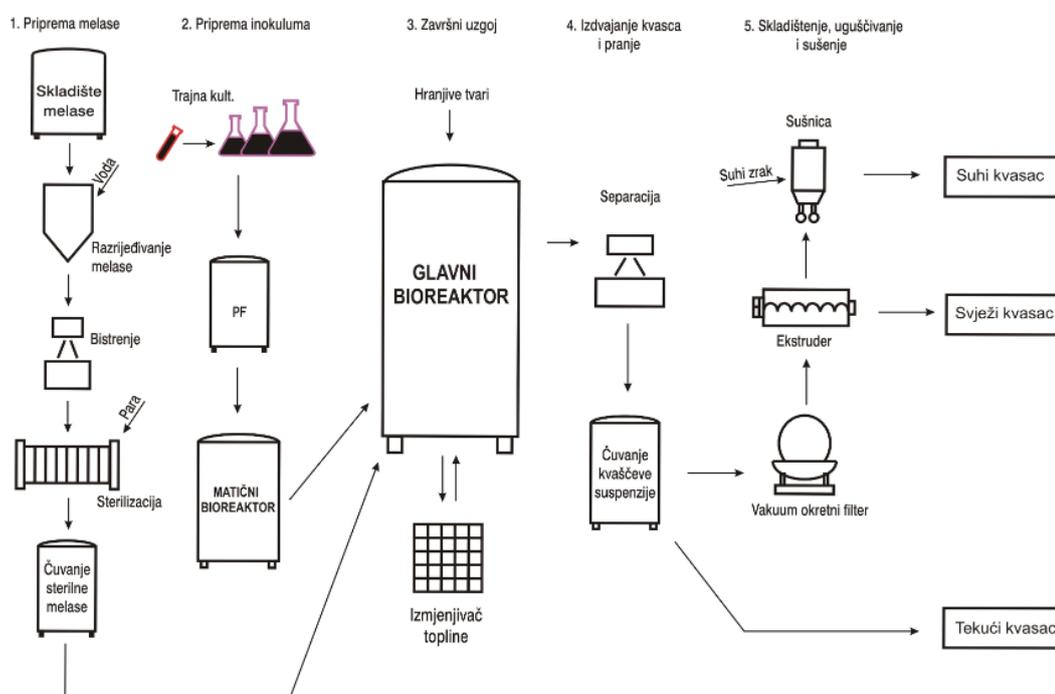
**Slika 6.** Osnovna shema proizvodnog procesa suhog, svježeg i tekućeg kvasca.<sup>14</sup>
