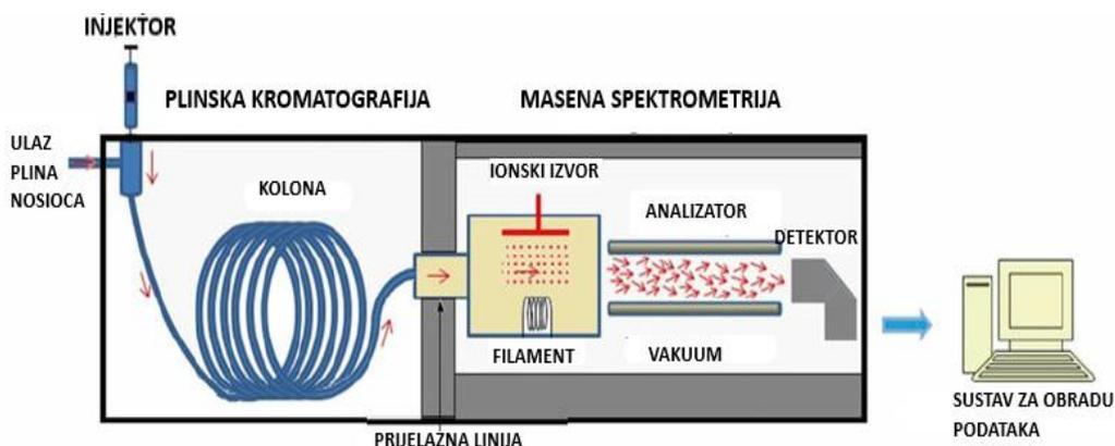
**Slika 15.** Shematski prikaz rada GC-MS uređaja.<sup>37</sup>
