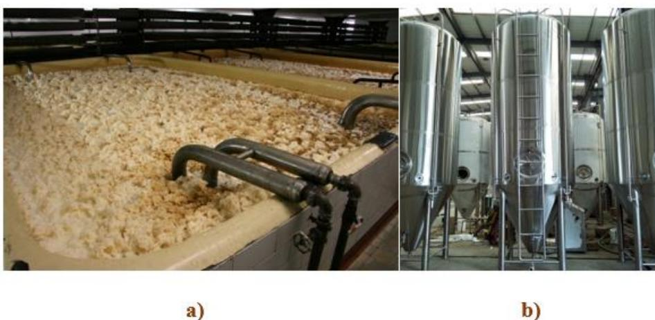
**Slika 12.** Fermentacija piva: a) otvoreni betonski bazen<sup>23</sup>; b) cilindrično-konusni spremnik.<sup>24</sup>
