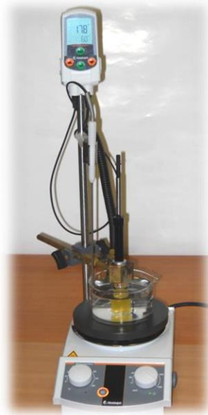
**Slika 16.** Aparatura za mikroekstrakciju vršnih para na krutoj fazi (HS-SPME).<sup>38</sup>
