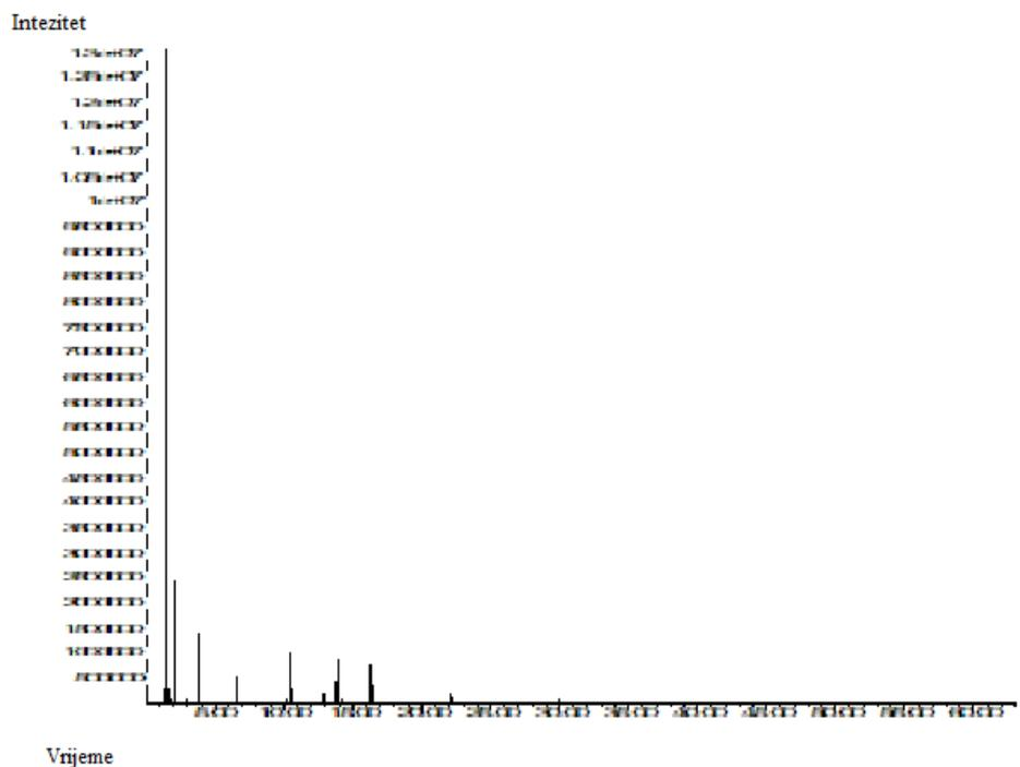
**Slika 22.** Kromatogram ukupne ionske struje hlapljivih spojeva piva stila *dunkel* izoliranih HS-SPME metodom s ovojnicom PDMS/DVB (plavo vlakno).
