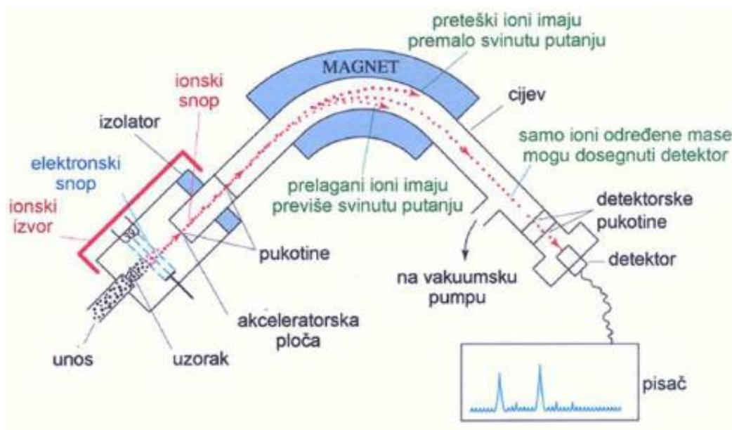
**Slika 14.** Shematski prikaz masenog spektrometra.<sup>35</sup>
