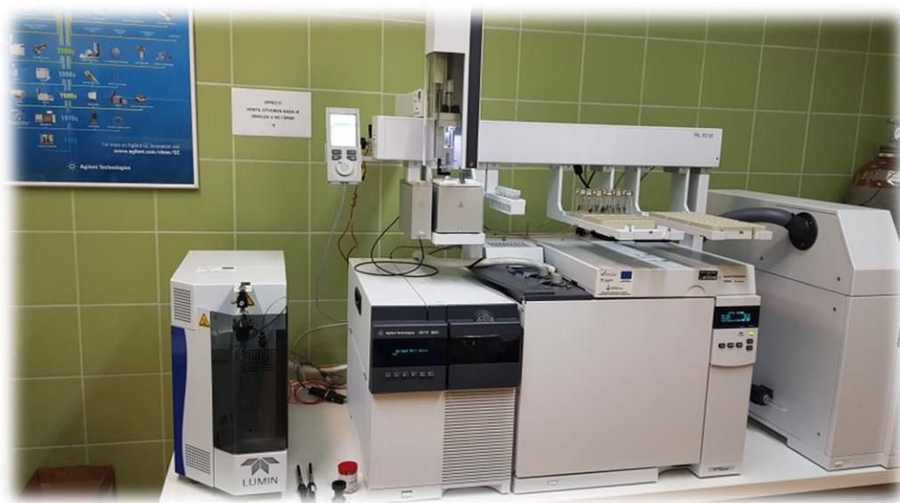
**Slika 18.** Vezani sustav plinska kromatografija-spektrometrija masa (GC-MS).<sup>38</sup>
