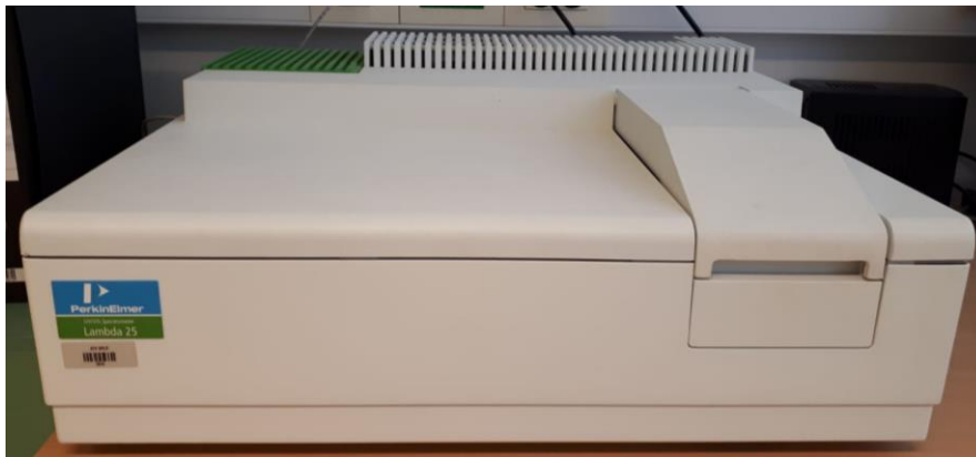
Slika 16. UV/Vis spektrofotometar Perkin Elmer Lambda 25
