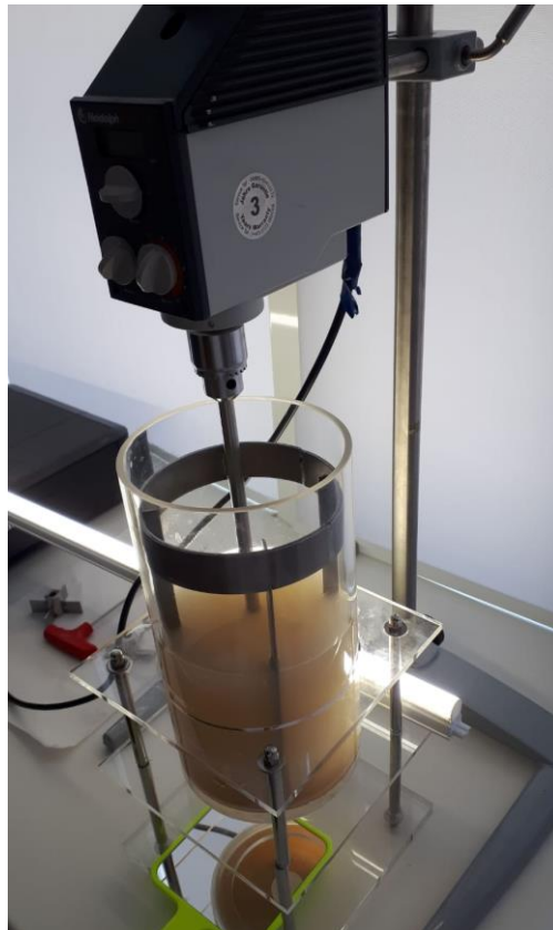
Slika 17. Reaktorski sustav korišten kod određivanja kritične brzine vrtnje miješala
