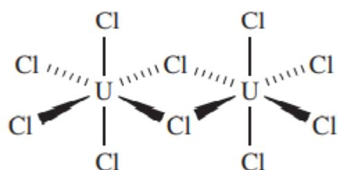
Slika 5. Dimer u strukturi uranijevog pentaklorida,  $\text{UCl}_5$  [7].
