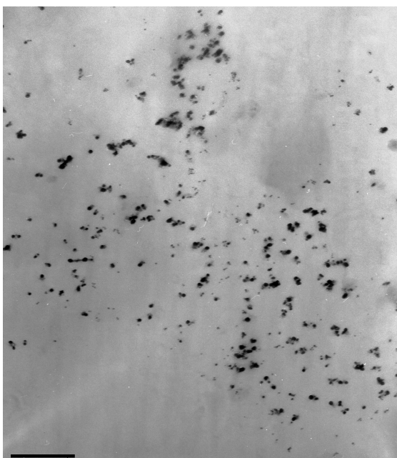
Slika 25. TEM snimka za dobivene koloide srebra u uzorku E4 (povećanje 16000X)
