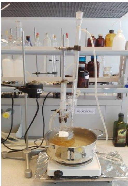
Slika 7. Aparatura za provedbu procesa transesterifikacije biljnog ulja
