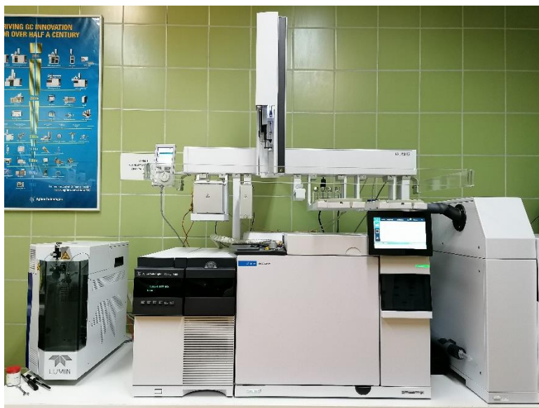
Slika 34. Vezani sustav plinska kromatografija-spektrometrija masa (GC-MS)
