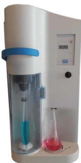
Slika 2.6. Uređaj za destilaciju uzorka.
