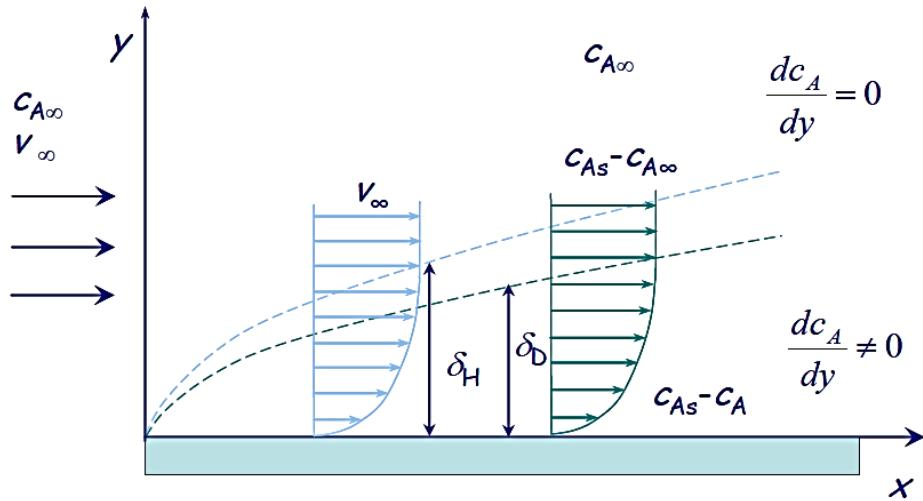
*Slika 3.* Hidrodinamički i difuzijski granični sloj.
