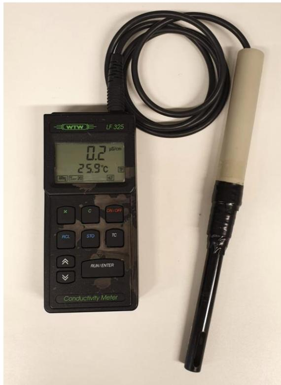
**Slika 7.** Konduktometar i konduktometrijska čelija.
