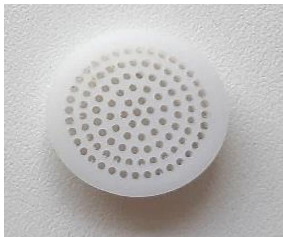
**Slika 6.** Difuzijska ćelija i njena pločica s kapilarnim otvorima.
