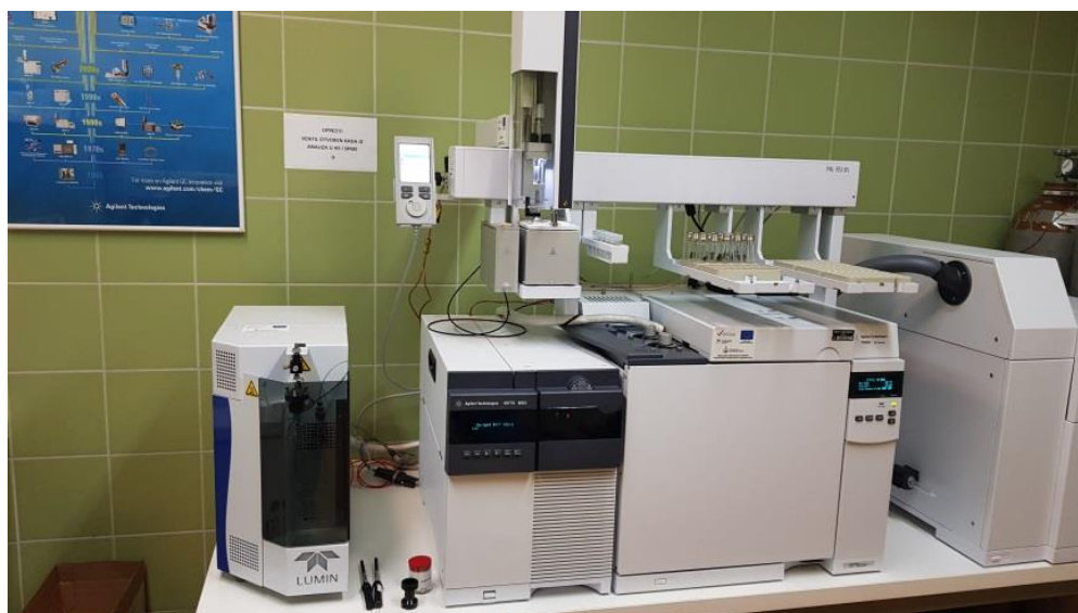
Slika 9. Vezani sustav plinska kromatografija-spektrometrija masa (GC-MS)
