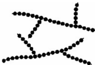
Slika 2. Shematski prikaz granatih makromolekula 1
