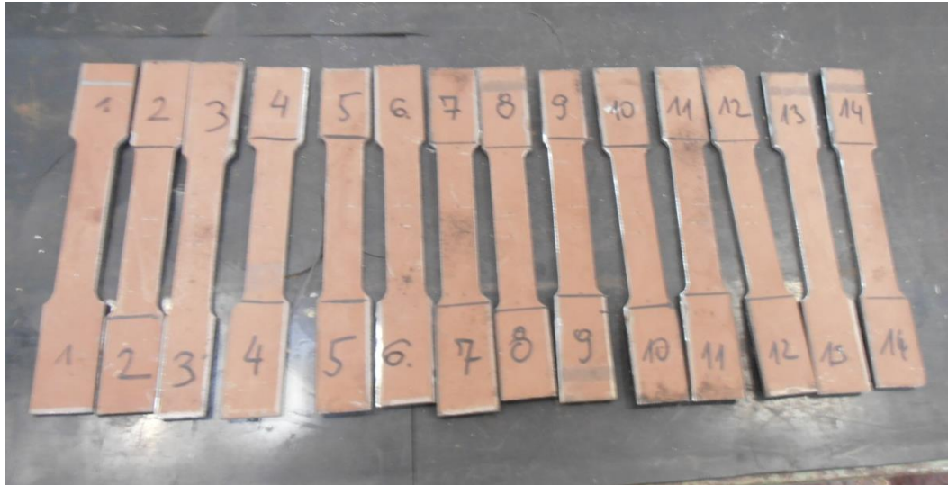
Slika 15. Epruvete za mehanička ispitivanja
