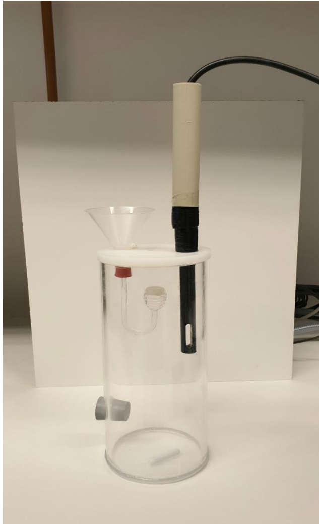
Slika 10. Posuda za određivanje koeficijenta difuzije.
