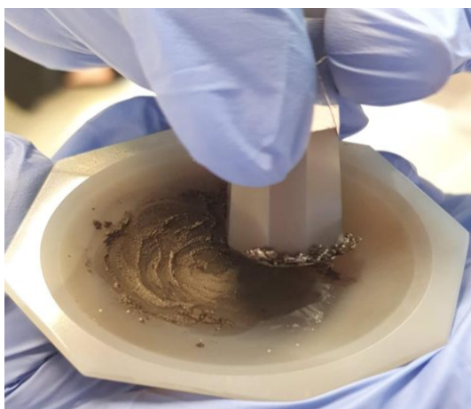
Slika 5. Priprema membrane u tarioniku
