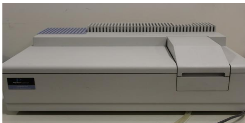
Slika 18. UV/VIS spektrofotometar PERKIN ELMER LAMBADA 25
