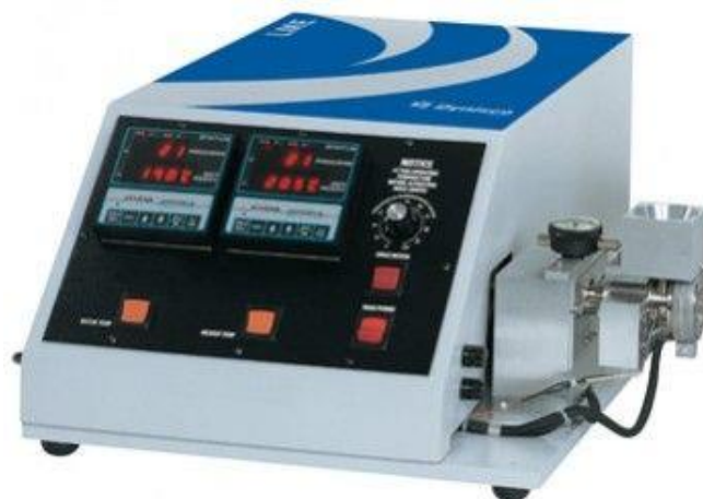
Slika 12. Laboratorijski jednopužni ekstruder Dynisco (Qualitest, SAD)
