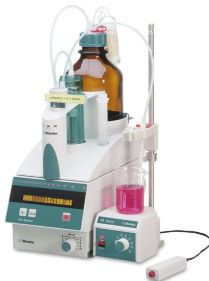
Slika 2.2 Automatski titrator “Metrohm 775 Dosimat”
