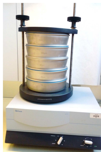
Slika 2.5 Uređaj za prosijavanje „Retsch AS 200 basic“
