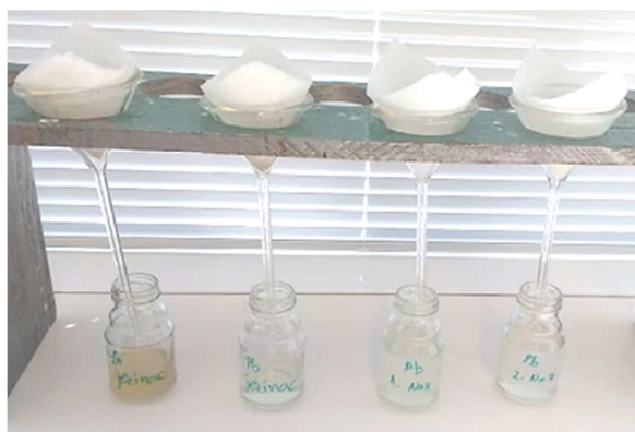
Slika 2.10 Filtriranje suspenzija nakon uravnoteženja
