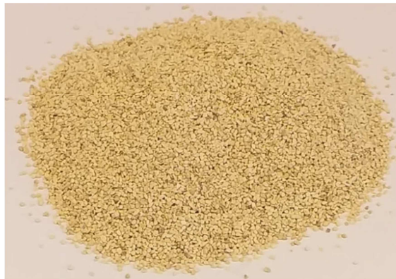
Slika 2.7 Prirodni zeolit klinoptilolit
