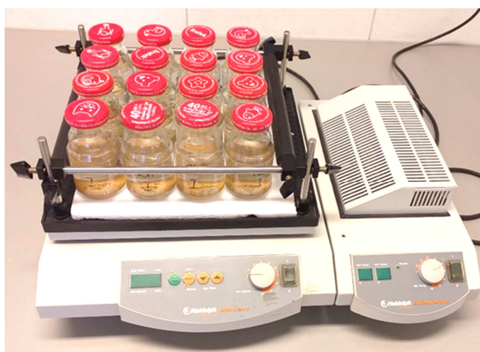
Slika 2.9 Uravnoteženje vodene otopine olova, odnosno cinka s različitim sorbentima na laboratorijskoj tresilici
