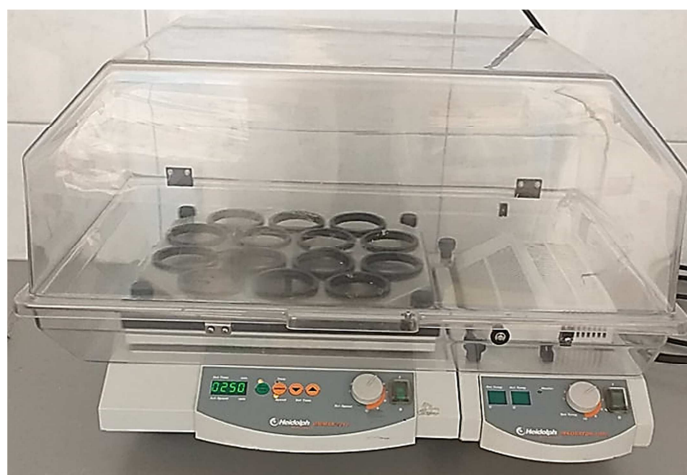
Slika 2.8 Inkubatorska tresilica „Heidolph Unimax 1010“
