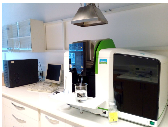
Slika 2.12 Atomski apsorpcijski plameni spektrometar PinAAcle 900F
