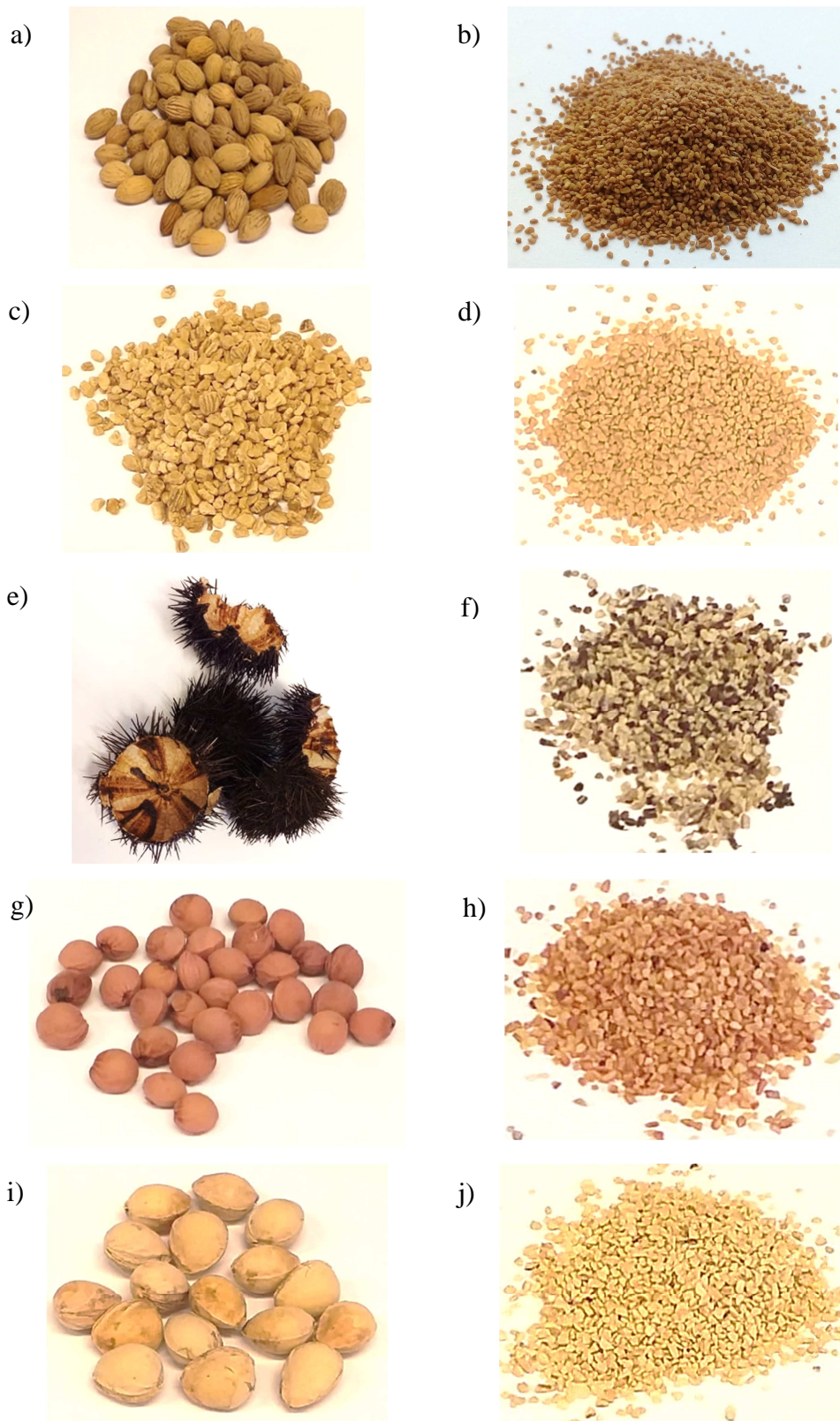
Slika 2.6 Sakupljeni i pripremljeni biosorbenti: a, b) čitave i usitnjene koštice maslina; c, d) krupni i usitnjeni pelet komine masline; e, f) krupni i usitnjeni ostaci hridinskog ježinca; g, h) čitave i usitnjene koštice višnje; i, j) čitave i usitnjene koštice trešnje 69
