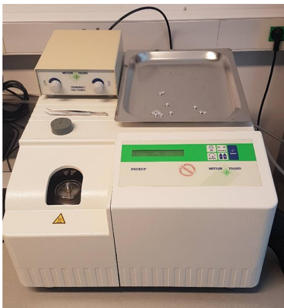
Slika 17. Diferencijalni pretražni kalorimetar DSC 823 e (Mettler Toledo)
