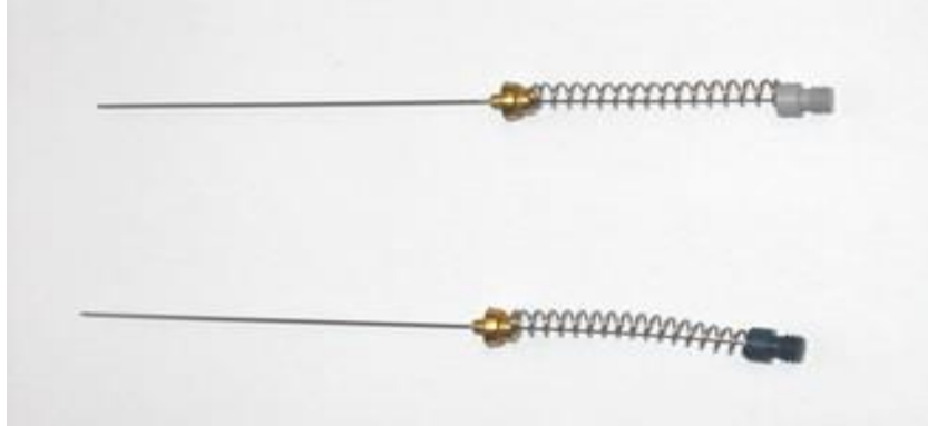
Slika 8. Vlakna s ovojnica DVB/CAR/PDMS (sivo vlakno) i PDMS/DVB (plavo vlakno) 21
