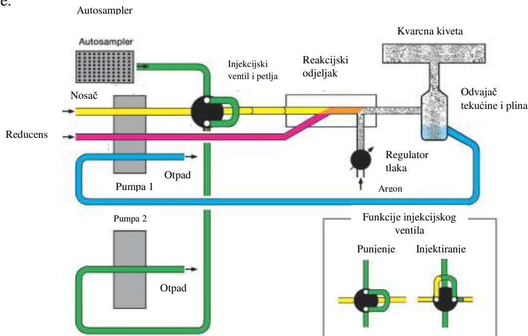
Slika 11. Instrumentacija hidridne tehnike<sup>15</sup>
