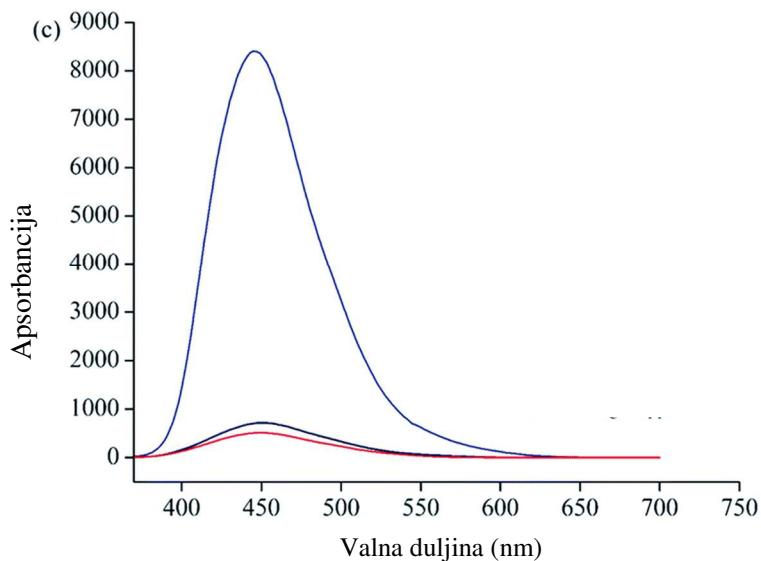
Slika 8. Ispis detektora na primjeru  $\text{Hg}^{2+}$ <sup>12</sup>
