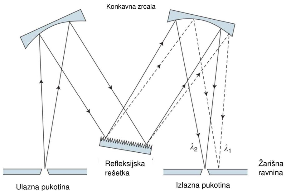
Slika 7. Monokromator sa refleksijskom rešetkom<sup>11</sup>
