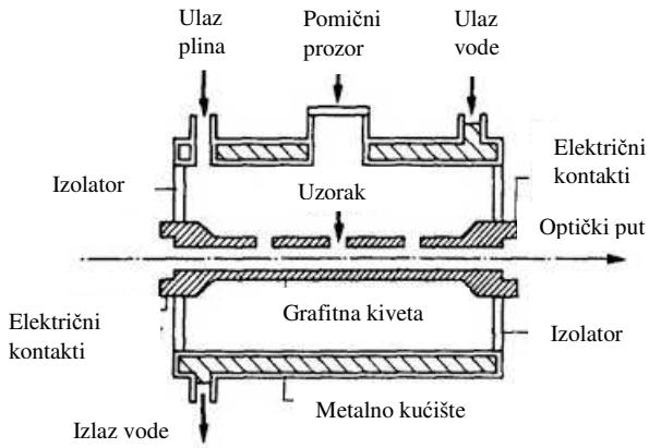
Slika 10. Prikaz grafitne kivete u peći<sup>14</sup>
