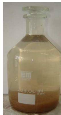
Slika 2.8. Pahuljasti talog nakon inkubacije
