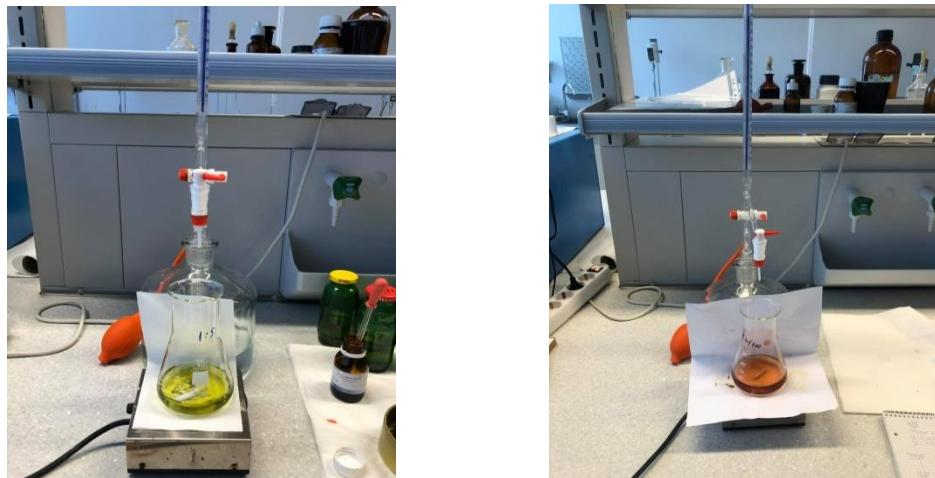
*Slika 2.6. Prijelaz boje pri titraciji uzorka uz indikator feroin*
