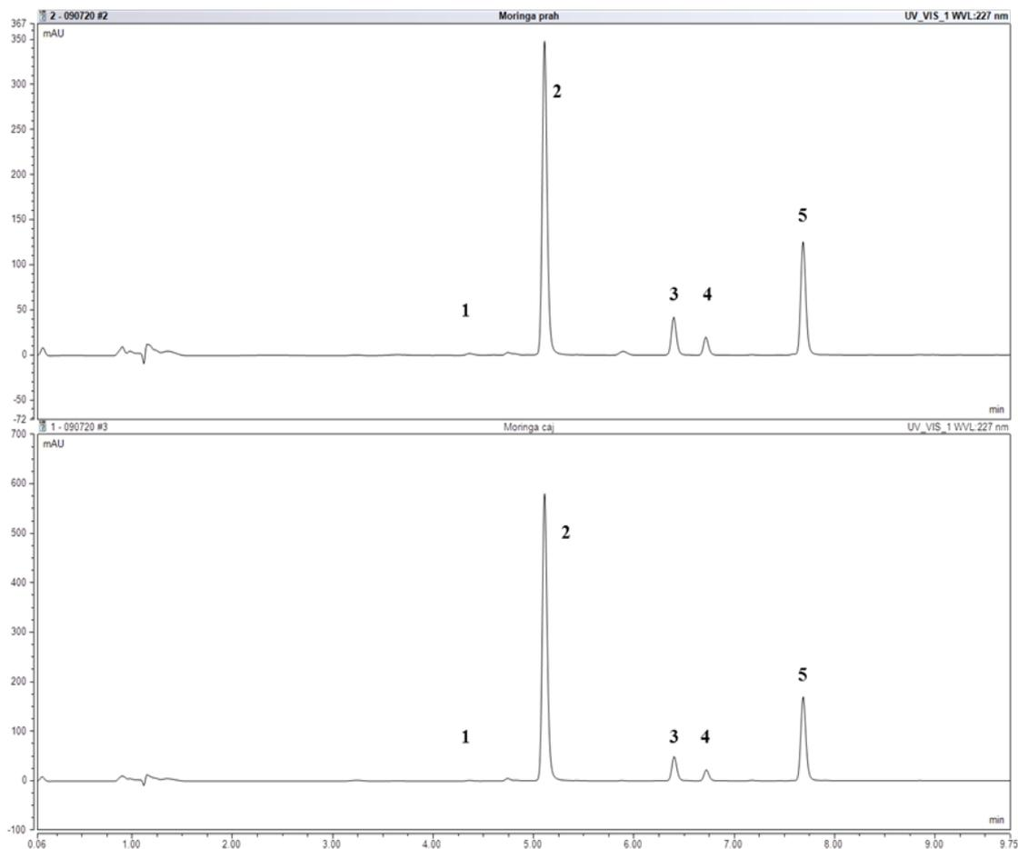
**Slika 3.2.** UHPLC kromatogrami desulfoglukozinolata: a) Moringa prah; b) Moringa čaj. 1 - desulfoglukosinalbin, 2 - desulfoglukomoringin, 3 - desulfo *O*-acetilirani izomer glukomoringina I, 4 - desulfo *O*-acetilirani izomer glukomoringina II, 5 - desulfo *O*-acetilirani izomer glukomoringina III.
