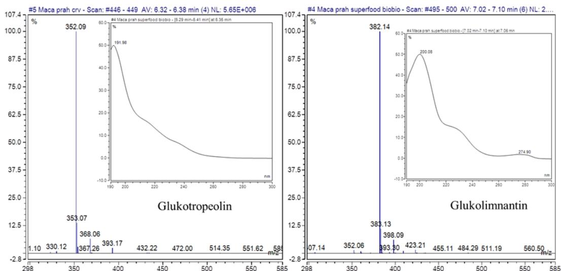
**Slika 3.2.** Maseni i UV spektri identificiranih desulfoglukozinolata.
