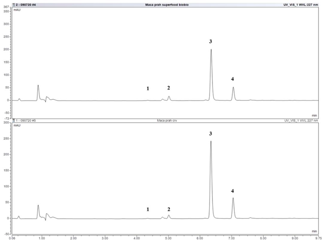
**Slika 3.1.** UHPLC kromatogrami desulfoglukozinolata: a) Maca žuti prah; b) Maca crveni prah. 1 - desulfoglukosinalbin, 2 - desulfoglukolepigramin, 3 - desulfoglukotropeolin, 4 - desulfoglukolimnantin.
