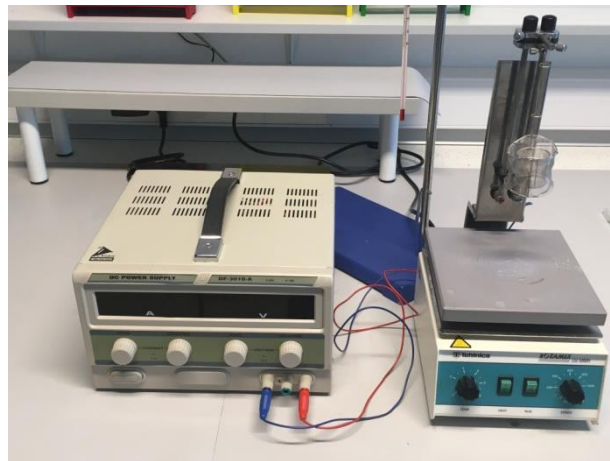
Slika 2-4 Uređaj za elektrogravimetrijsku analizu
