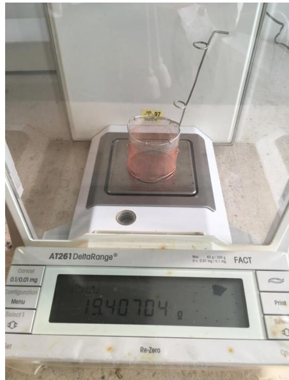
Slika 2-15a Platinska elektroda nakon elektrolize sa izlučenim bakrom; 2.15b postupak vaganja
