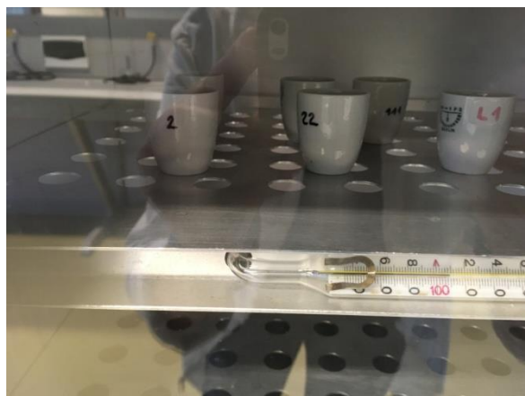
Slika 2-12 Lončići sa talogom u sušioniku
