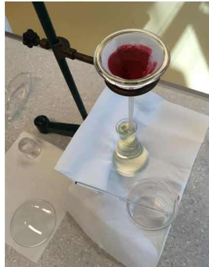
Slika 2-8 Filtracija otopine kroz lijevak
