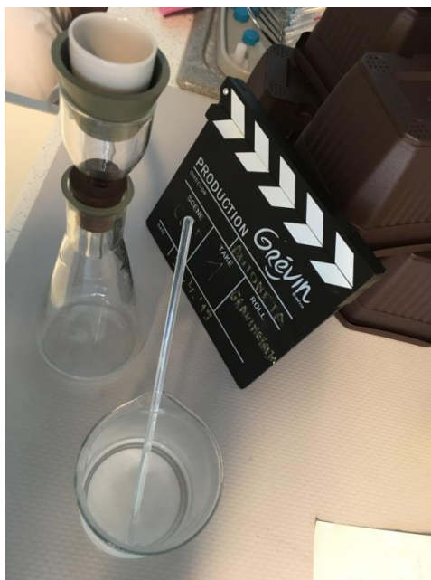
Slika 2-11 Uzorak spreman za filtriranje lijevkom za odsis
