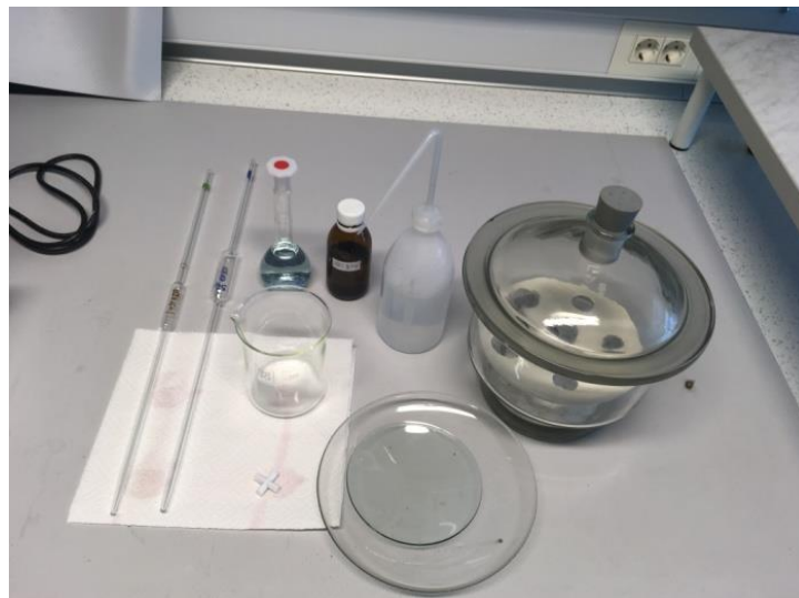
Slika 2-3 Pripremljena otopina te posuđe za elektrogravimetrijsko određivanje bakra
