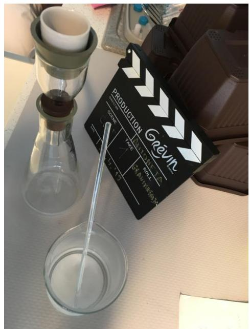
Slika 2-11 Uzorak spreman za filtriranje lijevkom za odsis
