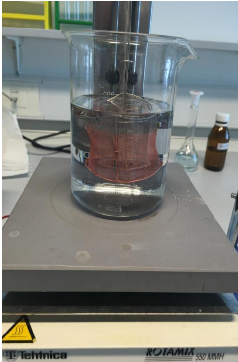
Slika 2-15a Platinska elektroda nakon elektrolize sa izlučenim bakrom; 2.15b postupak vaganja
