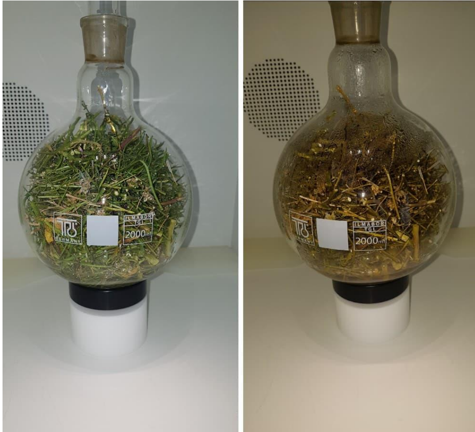
Slika 21. Biljni materijal prije i poslije mikrovalne destilacije.
