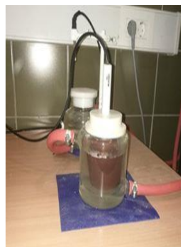
Slika 6. Mjerna posuda s uzorkom i uronjenom elektrodom
