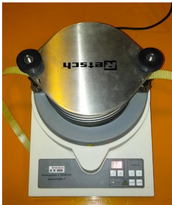
Slika 9. Fritsch analysette 3 spartan pulverisette 0 treskalica
