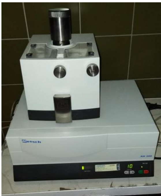
Slika 8. Mlin Retsch RM 200
