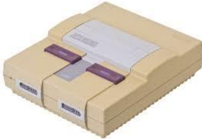
Slika 1. Žućenje plastičnog materijala 4
