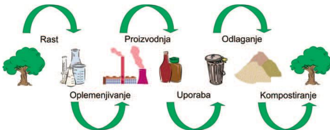
Slika 2. Tijek životnog ciklusa biorazgradljivog, kompostabilnog, polimernog materijala 6
