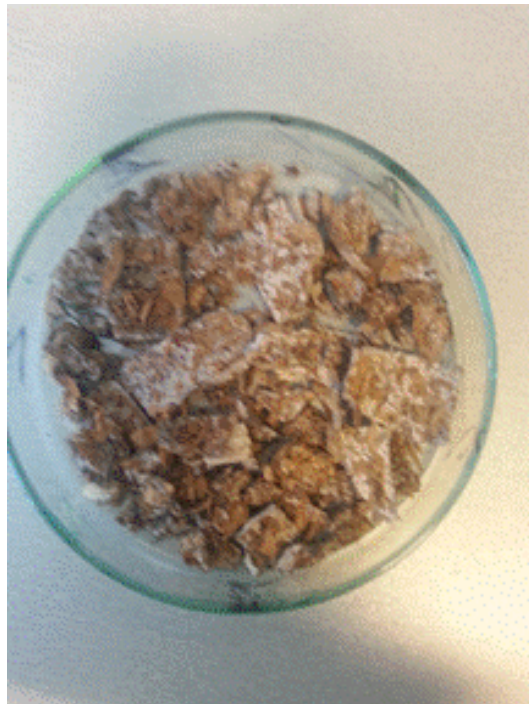
Slika 13. PLA uzorci nakon kompostiranja i sušenja
