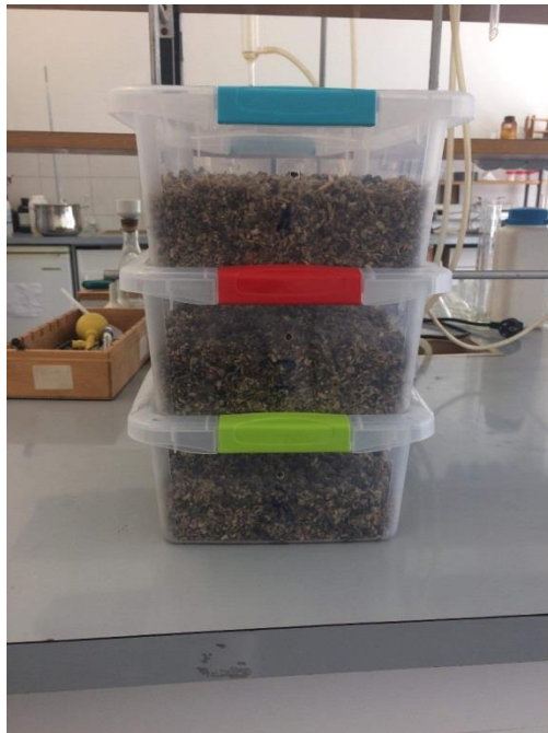
Slika 12. Vanjski izgled reaktora za kompostiranje
