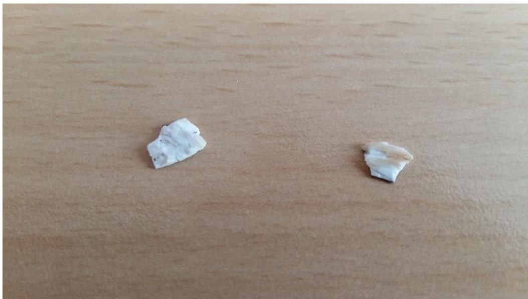
Slika 18. Najveći zaostali komadići PLA nakon kompostiranja (lijevo: najveća dimenzija- 8 mm, desno: najveća dimenzija: 6 mm)
