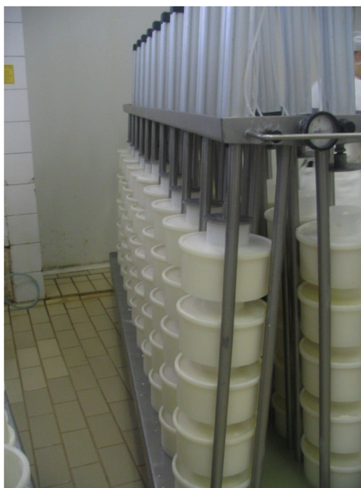
Slika 2. Prešanje Paškog sira ( Izvor: https://europa.ba/wp-content/uploads/2016/11/Sir_latinica.pdf ,pristupljeno 25.01.2020.) (41)
