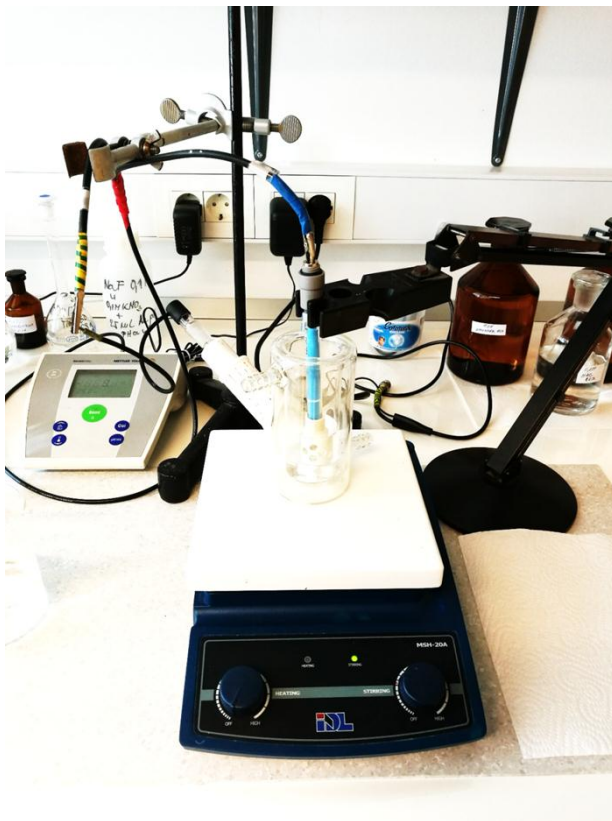
Slika 6. Uređaj za potenciometrijska određivanja 7
