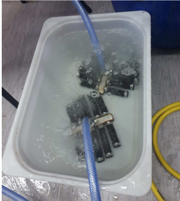
Slika 2.6. Spremnik za određivanje koncentracije otopljenog kisika u vodovodnoj vodi.
