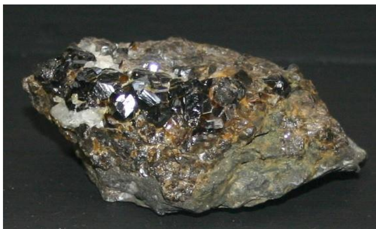
Slika 2. Uzorak kasiterita, glavne rude za dobivanje kositra. 5
