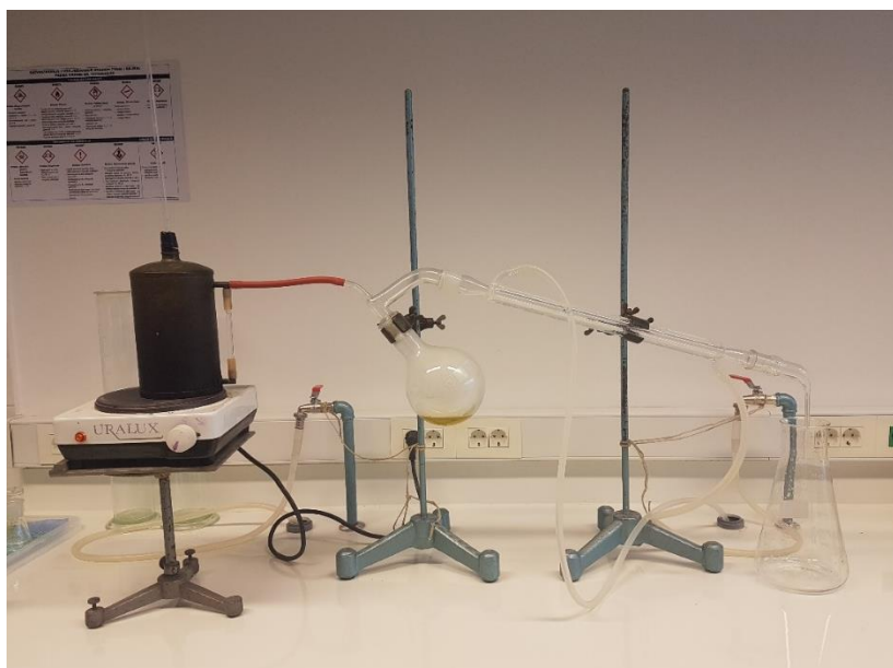
Slika 22. Destilacija vodenom parom
