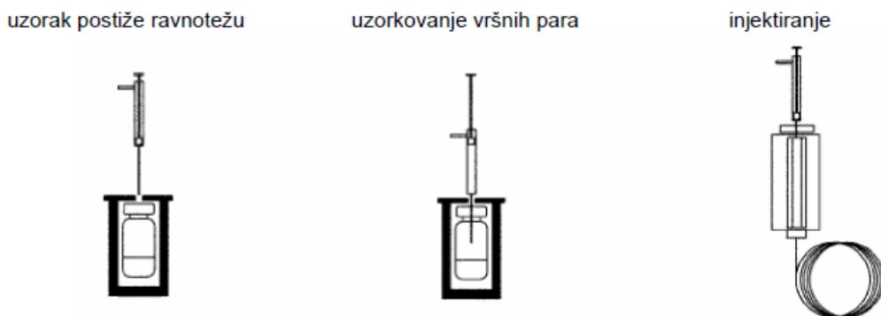
Slika 1.13. Statička tehnika vršnih para<sup>22</sup>
