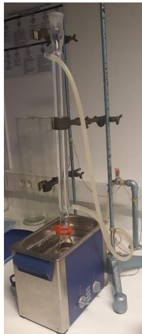
Slika 2.6. Aparatura za ultrazvučnu ekstrakciju
