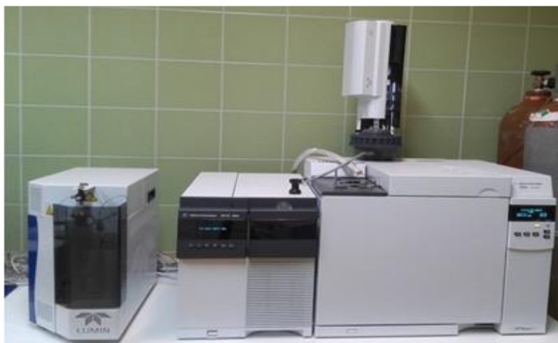
Slika 2.12. Vezani sustav plinska kromatografija-spektrometrija masa (GC-MS)
