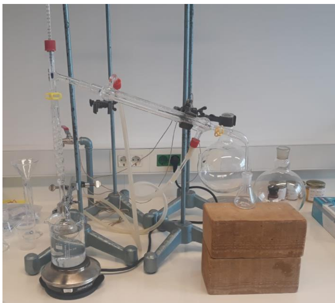
Slika 2.9. Koncentriranje ekstrakata frakcijskom destilacijom
