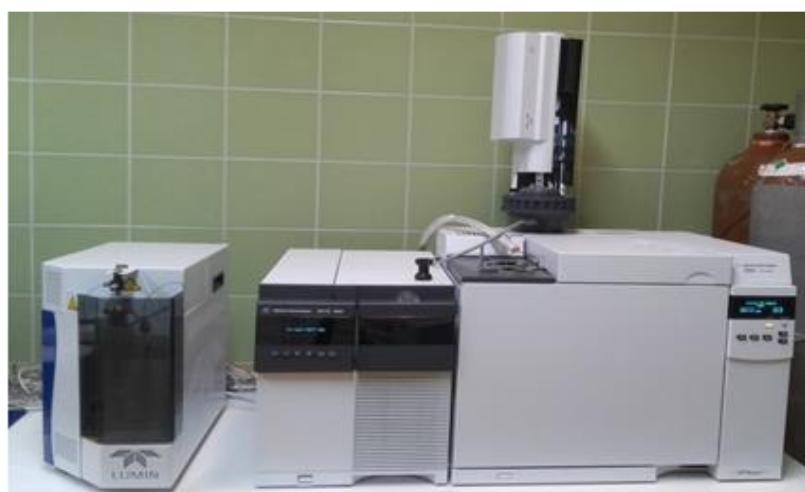
Slika 2.12. Vezani sustav plinska kromatografija-spektrometrija masa (GC-MS)
