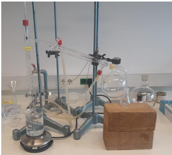
Slika 2.9. Koncentriranje ekstrakata frakcijskom destilacijom
