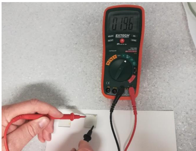
Slika 22. Određivanje vodljive strane stakalca pomoću multimetra
