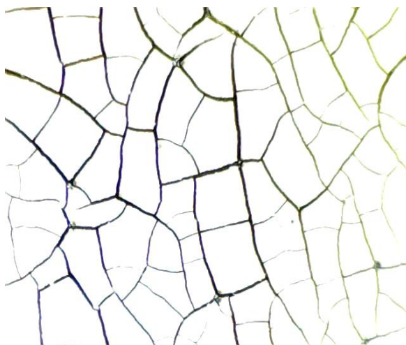
Slika 32. Izgled nanokristaličnog TiO 2 filma uz povećanje 200X
