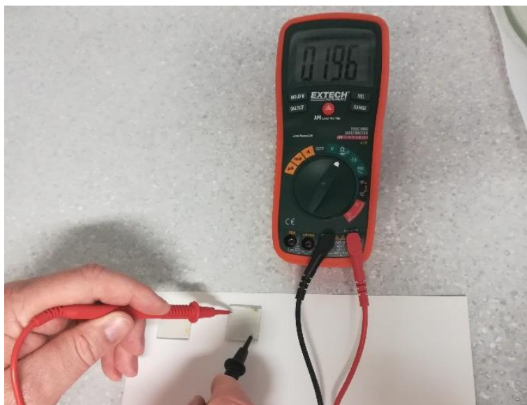
Slika 22. Određivanje vodljive strane stakalca pomoću multimetra
