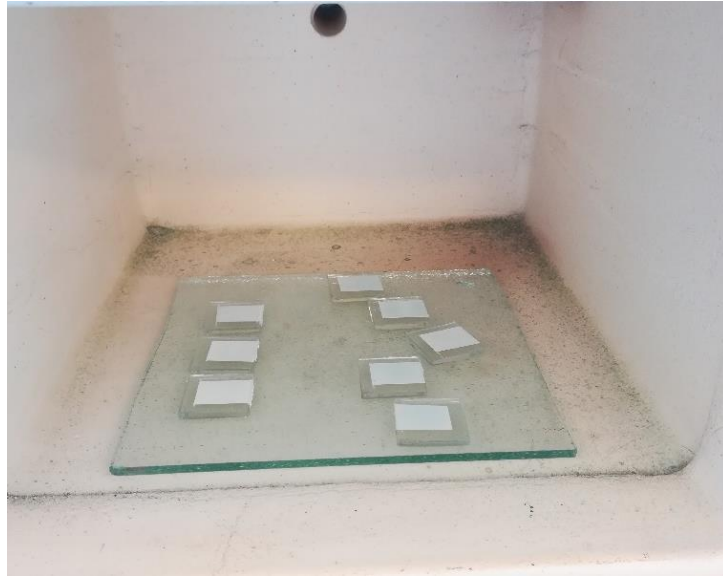
Slika 25. Pečenje oksidnog sloja u laboratorijskoj peći
