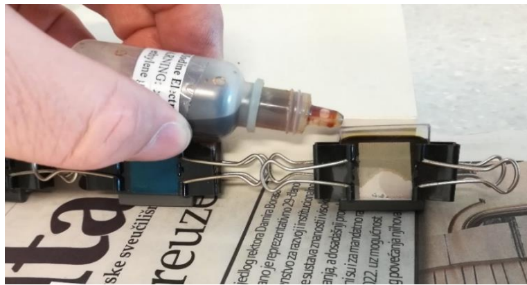
Slika 28. Dodatak otopine elektrolita
