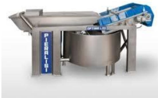
Slika 8. Hidropneumatski stroj za pranje maslina – perilica (12)
