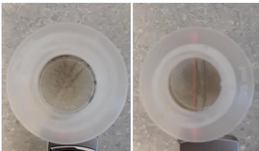
Slika 13. Provjera pojave Tyndallovog efekta u sintetiziranom uzorku koloidnog srebra pomoću askorbinske kiseline pri 50 °C, pogled odozgo
