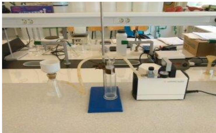
Slika 7. Vakuum filtracija pomoću Büchnerovog lijevka i vakuum pumpe
