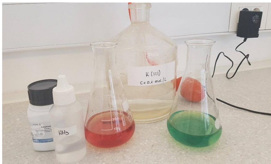
Slika 5. Prijelaz boje kod određivanja ukupne tvrdoće iz crvene u zelenu
