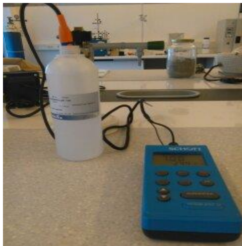
Slika 3. Baždarenje uređaja za mjerenje pH vrijednosti i specifične električne provodnosti
