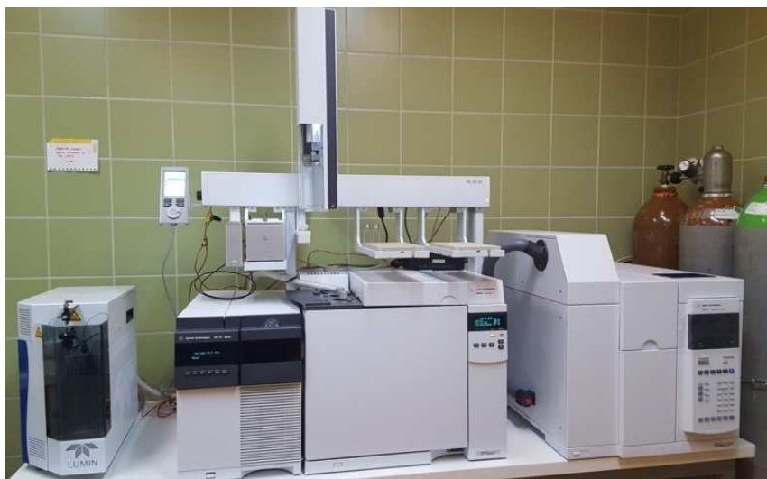
Slika 11. Spregnuta tehnika plinska kromatografija-spektrometrija masa (GC-MS)
