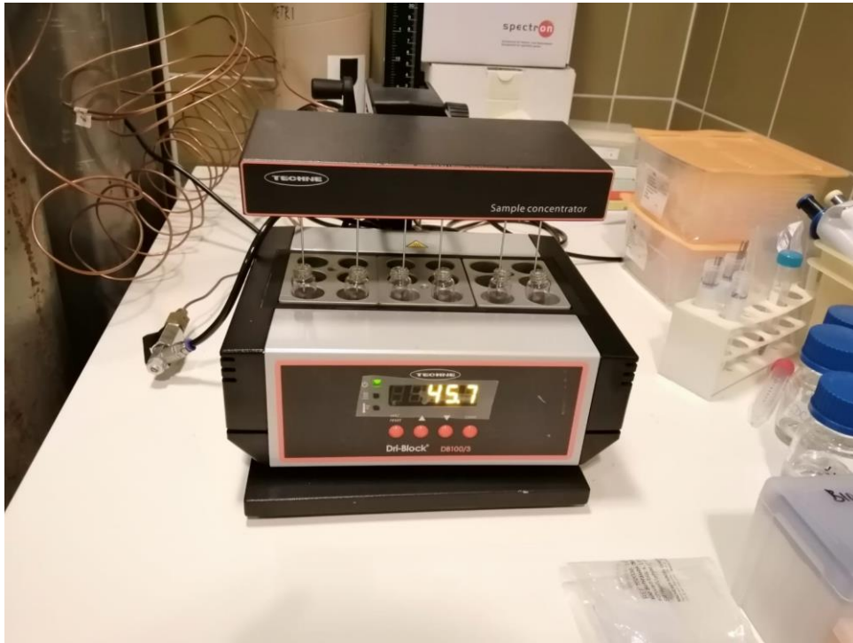
Slika 8. Prikaz uređaja za uparavanje
