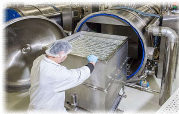
Slika 3. Termička obrada konzervirane ribe 4
