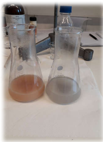
Slika 6. Prikaz završne točke titracije kod Mohr metode
