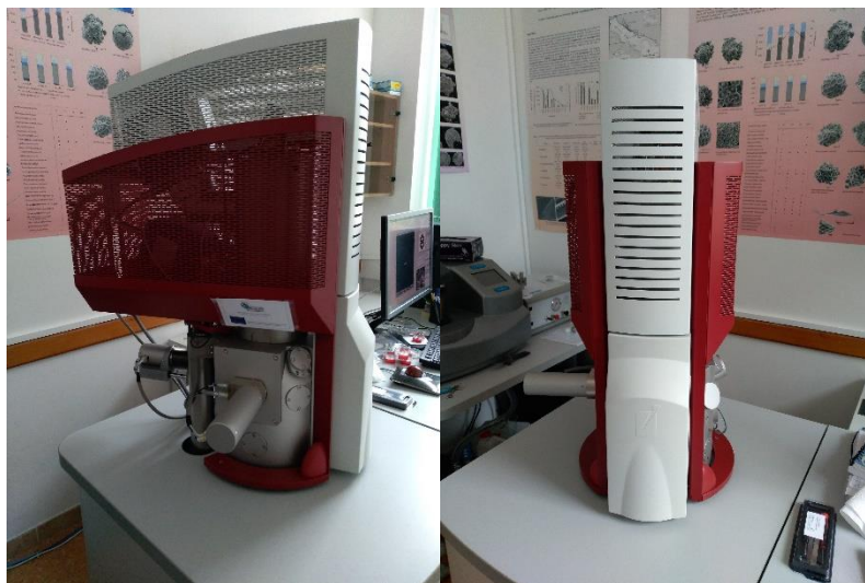
Slika 13. Pretražni elektronski mikroskop Tescan Mira 3
