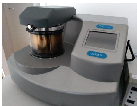
Slika 15. Uređaj za nanošenje zlata
