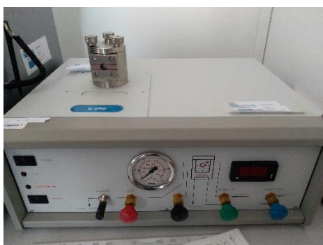
Slika 14. Sušilica na principu kritične točke
