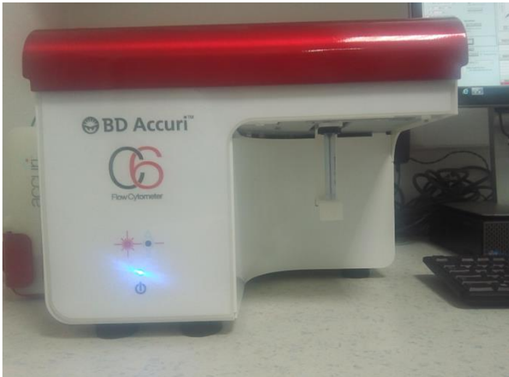
Slika 28. BD Accuri C6 protočni citometar
