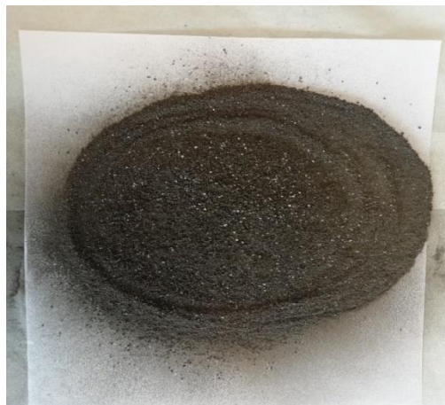
Slika 2.2 Uzorak humusa u koji je dodan leteći pepeo na koji je adsorbiran bakar
