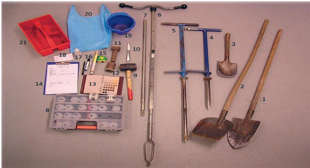
Slika 1.2 Pomagala i pribor za sondiranje i uzorkovanje tla 8
