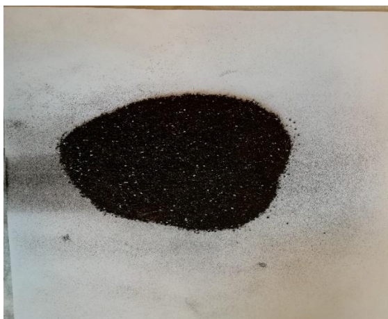
Slika 3.4 Uzorak humusa u koji su dodane ljuske jaja na koje je adsorbiran bakar
