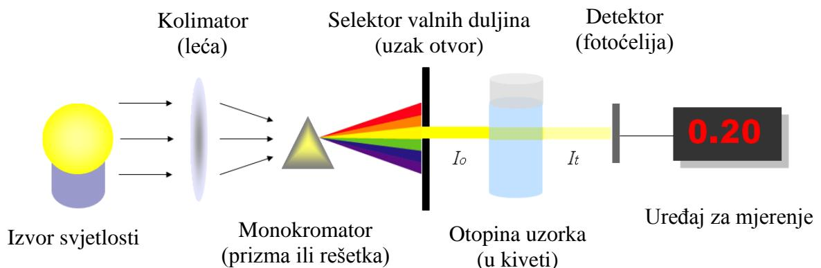
*Slika 1.3. Shematski prikaz spektrofotometra<sup>7</sup>*
