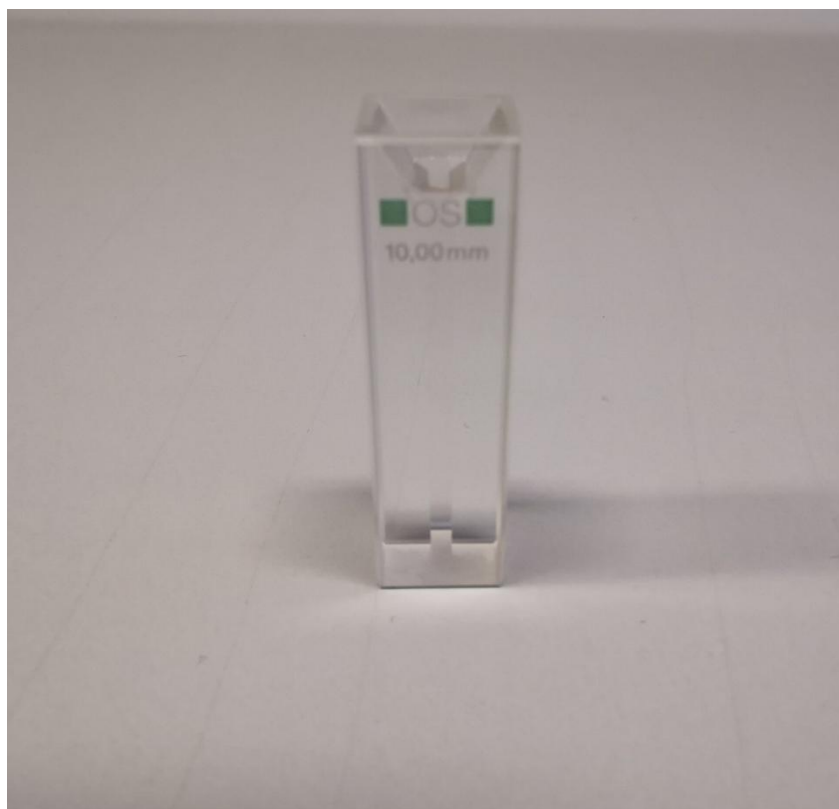
Slika 2.6. Kvarcna kiveta s otopinom uzorka
