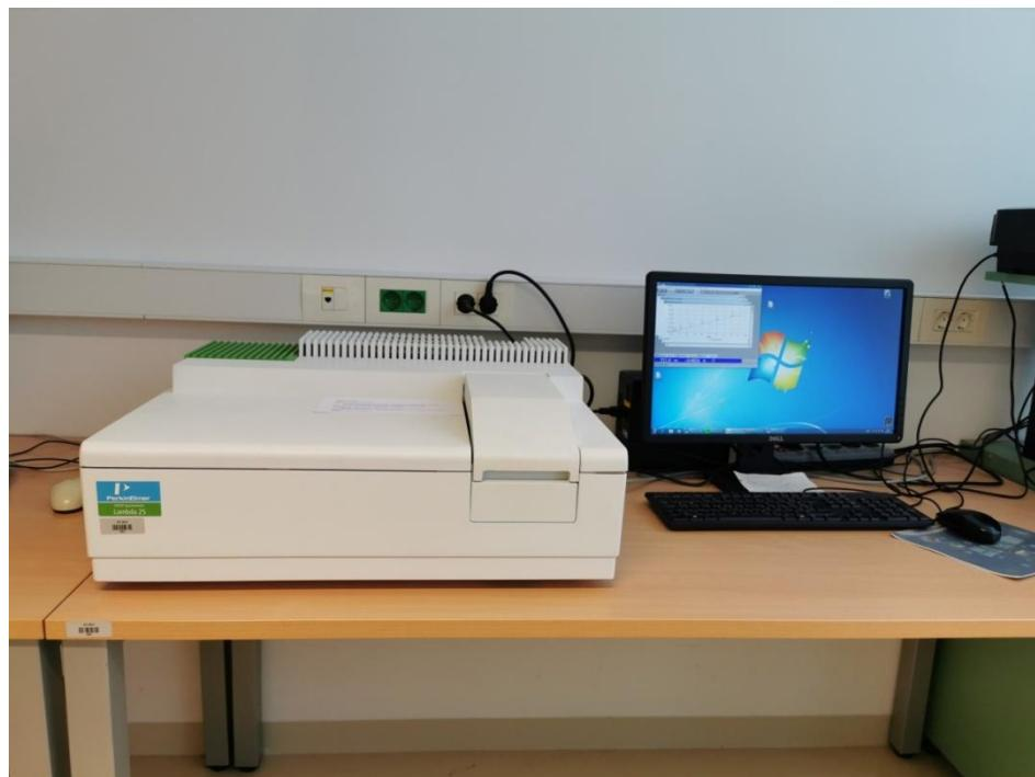
*Slika 2.4. Spektrofotometar Perkin Elmer Lambda 25*
