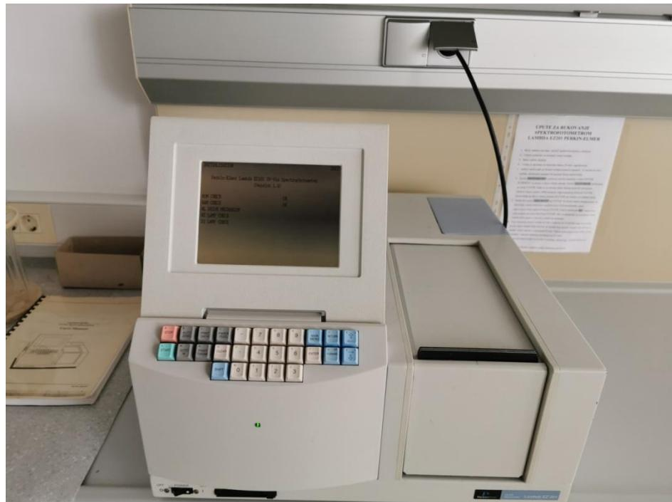
*Slika 2.5. Spektrofotometar Perkin Elmer Lambda EZ 201*
