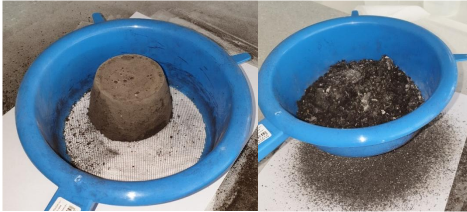
Slika 2.5. Priprema uzoraka tla prosijavanjem
