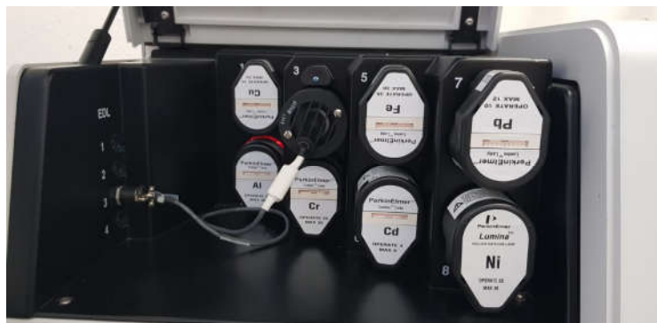
Slika 10. Žarulje sa šupljom katodom
