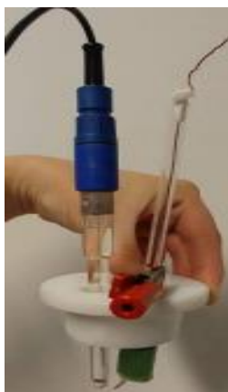
Slika 13. Referentna elektroda i protuelektroda
