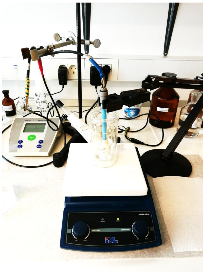
Slika 4. Uređaj za potenciometrijsko određivanje (slika preuzeta iz završnog rada studenta Marko Bačić)
