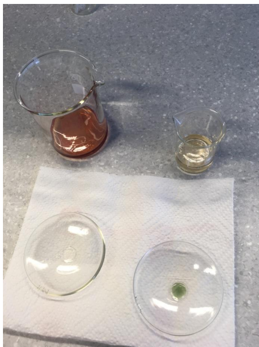
Slika 3.4. Dokazani molibden i željezo
