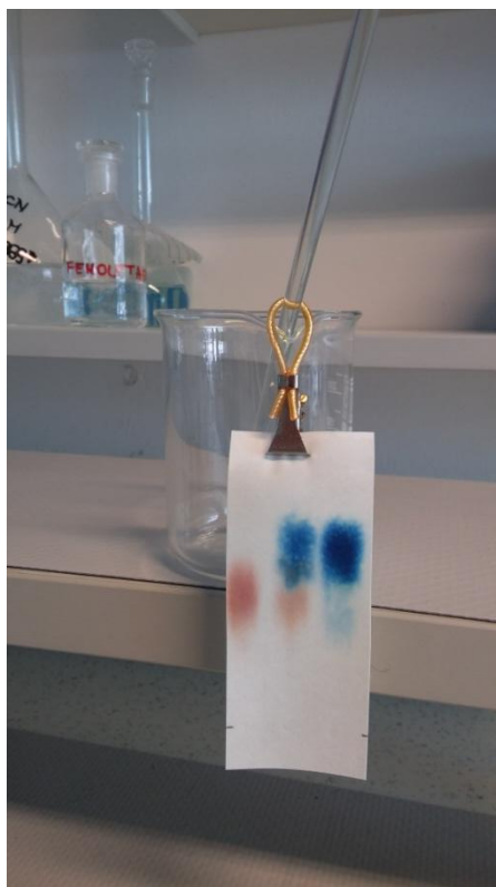
Slika 4.2. Kromatografska pločica nakon vizualizacije
