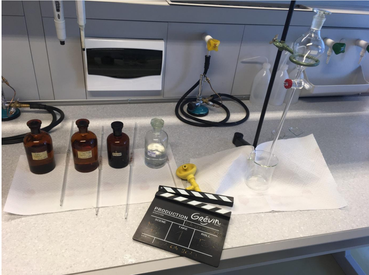
Slika 3.1. Prikaz aparature i kemikalija potrebnih za odjeljivanje iona željeza i molibdena postupkom ekstrakcije
