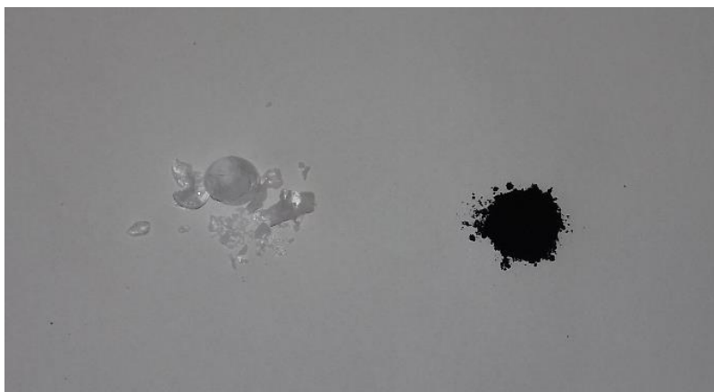
Slika 17 Krhkost pripravljenog gel materijala (lijevo), Usitnjeni kompozit ugljikovih nanocijevi i osjetilnog materijala u silikatnom materijalu (desno) pripravljen za inkorporiranje u osjetilni sloj
