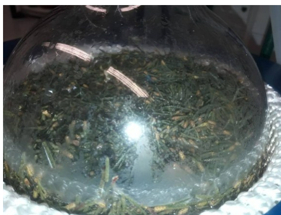
Slika 32. Izolacija eteričnog ulja vodenom destilacijom u aparaturi po Clevengeru
